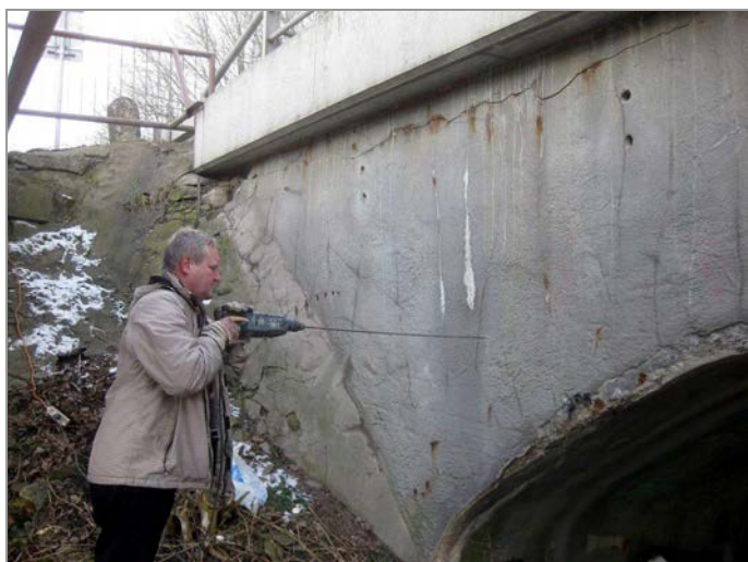
foto 11, 12: Ověřování tloušťky kamenného zdiva čela mostu a klenby
